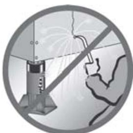
No utilice una manguera hidráulica para acarrear un componente hidráulico (es decir, bombas, cilindros y válvulas).
