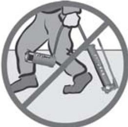
Ne pas laisser tomber d'objets lourds sur un flexible. Cela endommage ses torons métalliques et risque de causer sa rupture lorsqu'il est mis sous pression.
