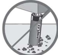
Lasten müssen auf dem Zylinderkolben zentriert sein. Seitlich versetzte Lasten führen zu Beschädigung der Zylinder und Kolben. Darüber hinaus könnte die Last ins Rutschen geraten oder fallen, was zu gefährlichen Situationen führen kann.
