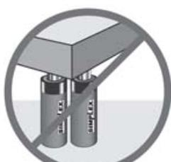
Die Last gleichmäßig über die gesamte Fläche des Druckstücks verteilen. Um seitliches Versetzen von Lasten zu reduzieren, sind Kippdruckstücke erhältlich.
