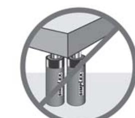
Il cilindro va collocato su una superficie piana in grado di sostenere il carico.
