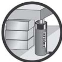
Un vérin ne doit jamais être utilisé pour maintenir une charge. Une fois la charge soulevée, elle doit être soutenue par des cales ou un cadre porteur.
