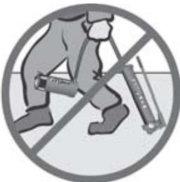
Keine scharfkantigen oder schweren Gegenstände auf den Schlauch fallen lassen, da dies die Drahtlitzen im Inneren des Schlauchs beschädigen kann. Wenn ein beschädigter Schlauch unter Druck gesetzt wird, kann dieser bersten.
