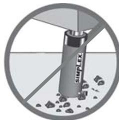
El cilindro debe estar colocado sobre una superficie plana capaz de soportar la carga.
