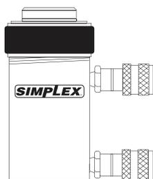
Eeguire i collegamenti oleodinamici. Con i cilindri a semplice effetto, usare una pompa con una valvola di scarico o una valvola a 3 vie e un tubo flessibile. Con i cilindri a doppio effetto, usare una pompa con una valvola a 4 vie e due tubi flessibili.
