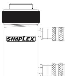
Effectuer les branchements hydrauliques. Utiliser une pompe à soupape de sûreté ou soupape à 3 voies et un seul flexible pour les vérins à simple effet. En utiliser une à soupape à 4 voies et deux flexibles pour les vérins à double effet.
