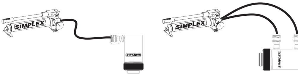
Vérin à simple effet : positionner le vérin de façon à ce qu'ils soit plus bas que la pompe et que son piston soit dirigé vers le bas. L'étirer et le rétracter à fond 2 ou 3 fois.
