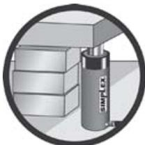
Non utilizzare mai un cilindro come dispositivo di sostegno di un carico. Dopo aver sollevato il carico, sostenerlo mediante blocchi o un'armatura di legno.
