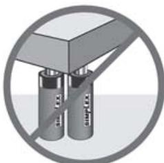
Las cargas deben estar centradas sobre el émbolo del cilindro. Las cargas descentradas dañarán los cilindros y los émbolos. Además, la carga podría resbalar y caerse, con resultados potencialmente peligrosos.
