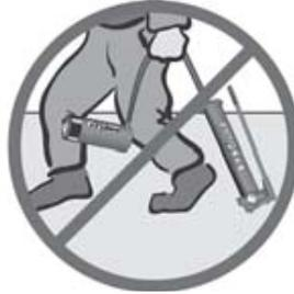
No deje caer objetos pesados ni afilados sobre una manguera. Esto causará daños internos en los alambres de la manguera. Si se aplica presión a una manguera dañada, se podría causar su rotura.
