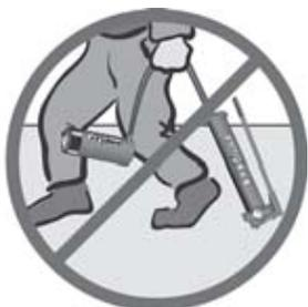
Non lasciar cadere oggetti pesanti sui tubi flessibili, perché se ne danneggerebbero gli strati di fibre intrecciate. Un tubo flessibile danneggiato può spezzarsi quando è percorso da fluido in pressione.
