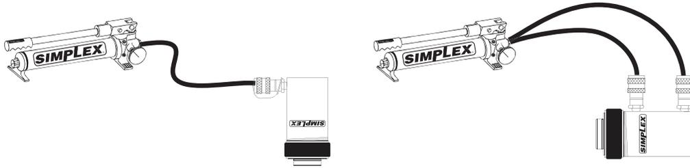
Einfachwirkende Zylinder: Den Zylinder so ausrichten, daß der Kolben nach unten zeigt und der Zylinder niedriger liegt als die Pumpe. Den Zylinder zwei - oder dreimal voll aus - und einfahren.
