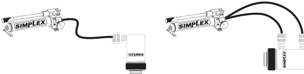
Cilindri a semplice effetto: collocare il cilindro a un'altezza inferiore rispetto alla pompa e con il pistone rivolto verso il basso. Fare eseguire al cilindro 2 o 3 corse complete di estensione e ritrazione.
