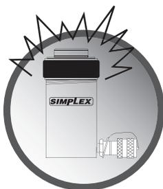
Ne jamais essayer de soulever une charge plus lourde que celle autorisée par la capacité nominale du vérin. Le levage d'une charge trop lourde peut endommager le matériel et entraîner des blessures.
