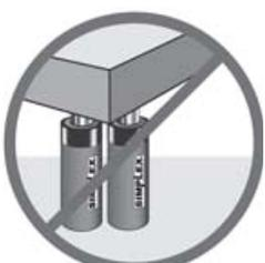
Les charges doivent être centrées sur le piston du vérin. Les charges décentrées endommagent les vérins et leurs plongeurs. En outre, la charge risque de glisser ou de tomber, avec des conséquences potentiellement dangereuses.
