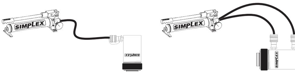
Cilindros de acción única: Coloque el cilindro de modo que el émbolo apunte hacia abajo y el cilindro esté más bajo que la bomba. Extienda y retraiga el cilindro del todo 2 ó 3 veces.
