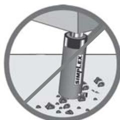
Il cilindro va collocato su una superficie piana in grado di sostenere il carico.
