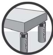
Lasten müssen auf dem Zylinderkolben zentriert sein. Seitlich versetzte Lasten führen zu Beschädigung der Zylinder und Kolben. Darüber hinaus könnte die Last ins Rutschen geraten oder fallen, was zu gefährlichen Situationen führen kann.
