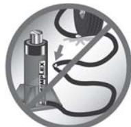
Éviter de plier et de vriller les flexibles hydrauliques lors de leur acheminement. Les pliages et vrillages endommagent l'intérieur des flexibles, ce qui conduit à une défaillance prématurée de ceux-ci.
