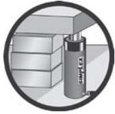
Nunca debe usarse un cilindro hidráulico como dispositivo para sujetar cargas. Después de levantar la carga, ésta debe ser sustentada por bloques o por un armazón de sustentación.
