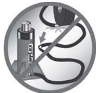
Evite las curvas pronunciadas y no retuerza las mangueras hidráulicas al colocarlas. Este tipo de deformaciones causará daños internos a la manguera, provocando fallos prematuros de la misma.
