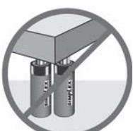
Le vérin doit être placé sur une surface plane capable de supporter la charge.
