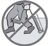
No deje caer objetos pesados ni afilados sobre una manguera. Esto causará daños internos en los alambres de la manguera. Si se aplica presión a una manguera dañada, se podría causar su rotura.
