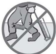
Non lasciar cadere oggetti pesanti sui tubi flessibili, perché se ne danneggerebbero gli strati di fibre intrecciate. Un tubo flessibile danneggiato può spezzarsi quando è percorso da fluido in pressione.
