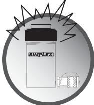
Ne jamais essayer de soulever une charge plus lourde que celle autorisée par la capacité nominale du vérin. Le levage d'une charge trop lourde peut endommager le matériel et entraîner des blessures.
